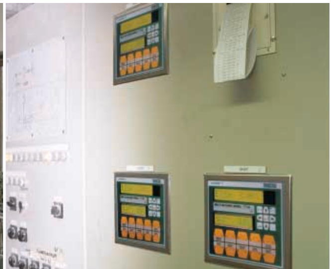
T- ja Z-järjestelmissä on punnituksen tietokoneohjaus. Lujarakenne ja luotettava toiminta tekee niistä ihanteellisia ratkaisuja hihnavaakasovelluksiin.
