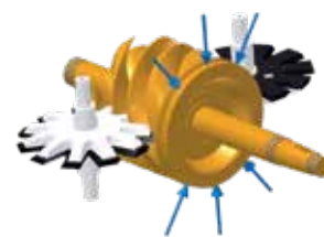
Radiaalikuormitukset vaikuttavat pääroottorin ylä- ja alapuoleen.
