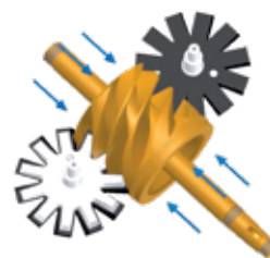
Aksiaalikuormitukset vaikuttavat pääroottorin molemmin puolin.
