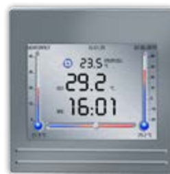
Yksinkertainen valvomo: HZS 351, kosketusnäyttö ja sisäinen lämpötilan anturi.
